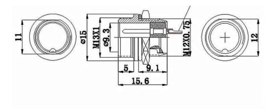
外壳材质:锌合金 Shell Material:Zinc alloy 尾部过线直径 Termination diameter
